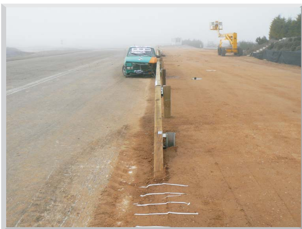
ENSAYO TB11 : Turismo 900 Kg, Velocidad 100 Km/h, Ángulo 20°
