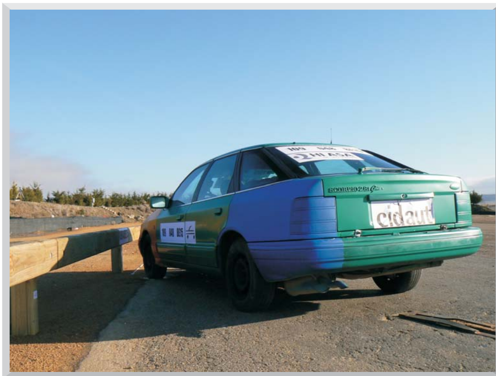
ENSAYO TB32 :Turismo 1500 Kg, Velocidad 110 Km/h, Ángulo 20°
