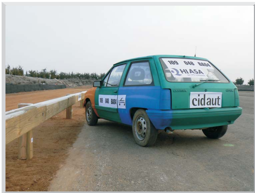
ENSAYO TB11 : Turismo 900 Kg, Velocidad 100 Km/h, Ángulo 20°
